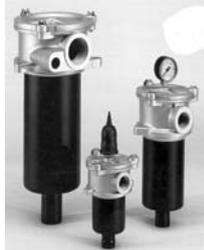
Верхняя крышка из литого алюминия. Стакан стальной или из стеклонейлона погружается в бак. Входные отверстия от 3/8" до 2". Испытательное давление 0,5 МПа, разрывное 1,0 МПа.
