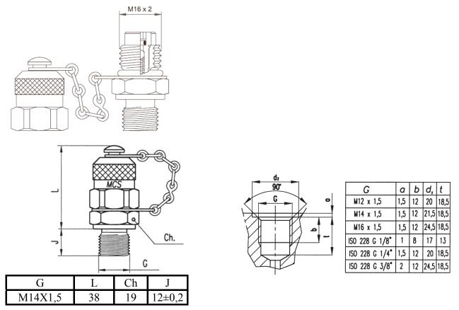
Рис.1. Габаритные и присоединительные размеры ниппель-манометра M14X1,5 (620.01.014.21) и отверстия под его установку
